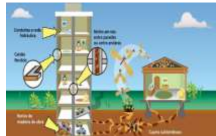
Os cupins se aproveitam de todos os acessos possíveis, sendo eles; vãos perdidos, conduítes e redes hidráulicas, vãos entre paredes ou entre os andares.
