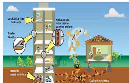
Os cupins se aproveitam de todos os acessos possíveis, sendo eles; vãos perdidos, conduites e redes hidráulicas, vãos entre paredes ou entre os andares.
