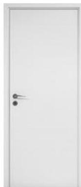
Porta pronta acabada com miolo sólido em madeira reflorestada de Pinus ou painel de madeira composta, com usinagem do berço da fechadura e capa em HDF (Placa de Fibra de Alta Densidade) com revestimento melamínico branco. Alizar e marco com encaixe regulável, maciços ou em laminado. Inclui três dobradiças e fechadura externa com maçaneta (considerar o padrão mais básico). Folha pesada (entre 20 e 30 kg/m<sup>2</sup>), conforme NBR 15930.
