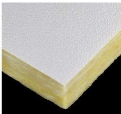
Forro modular de lã de vidro revestido na face aparente com PVC branco microperfurado. Módulos de 1250 x 625 mm e espessura de 15 mm, aproximadamente. Borda reta e densidade de aproximadamente 60kg/m<sup>3</sup>.
